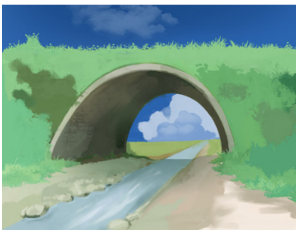
Rys. 87. Przepust/most z naturalnym dnem [Przybyła 2002, zmieniony]
