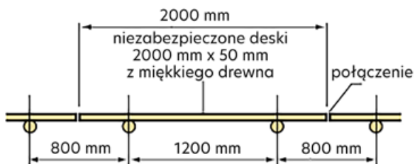
Rys. 74. Schemat deskowania krawędzi brzegu [Krukowski 2006]
